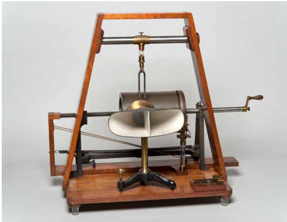
De noëmatachograaf, het meetinstrument waarmee Donders 150 jaar geleden voor het eerst menselijke reactietijden in de hersenen heeft vastgelegd. Foto: Universiteitsmuseum Utrecht
